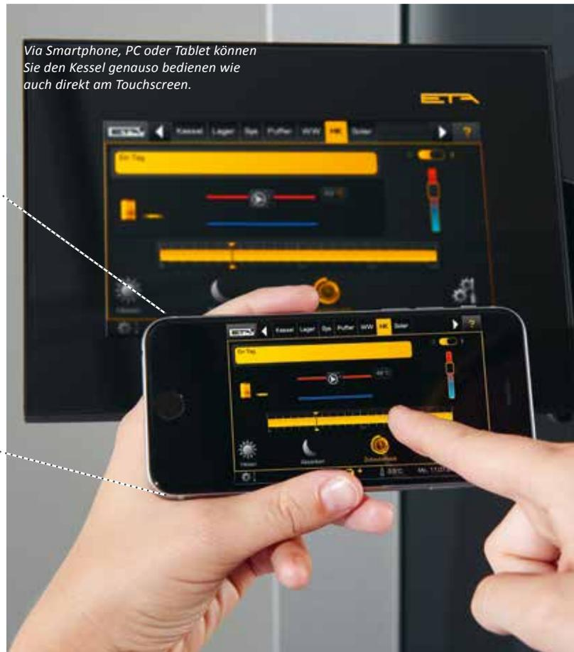
*Via Smartphone, PC oder Tablet können Sie den Kessel genauso bedienen wie auch direkt am Touchscreen.*
